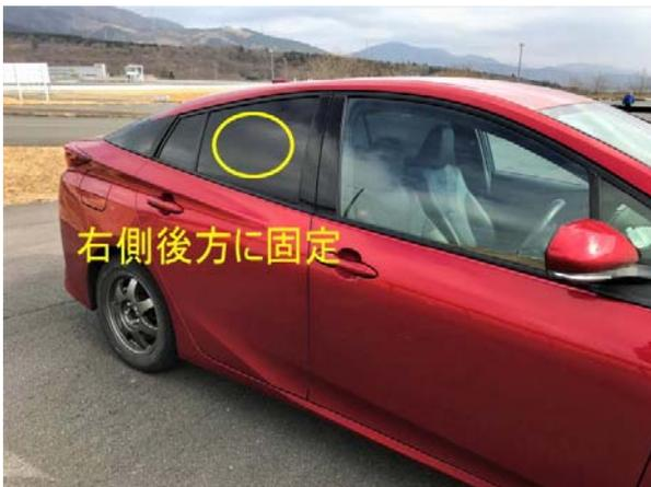
③ 右後方の窓内側に布製ガムテープで取り付けます。室内に取り付けることにより脱落時の破損を回避できます。
